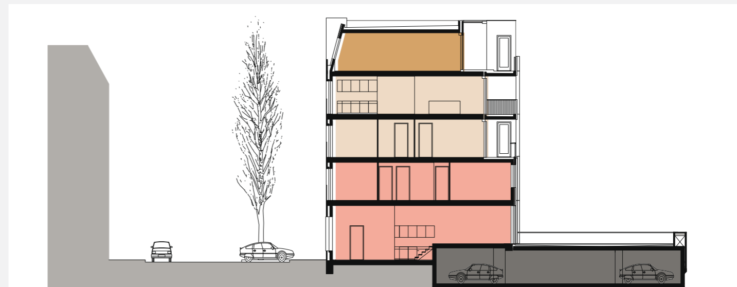
DOORSNEDEN VAN HET WOONBLOK. ONDERIN DE HALFVERDIEPTE GARAGE EN PLATTEGROND VAN DE BOUWLOCATIE IN DE 3 E OOSTERPARKSTRAAT.
